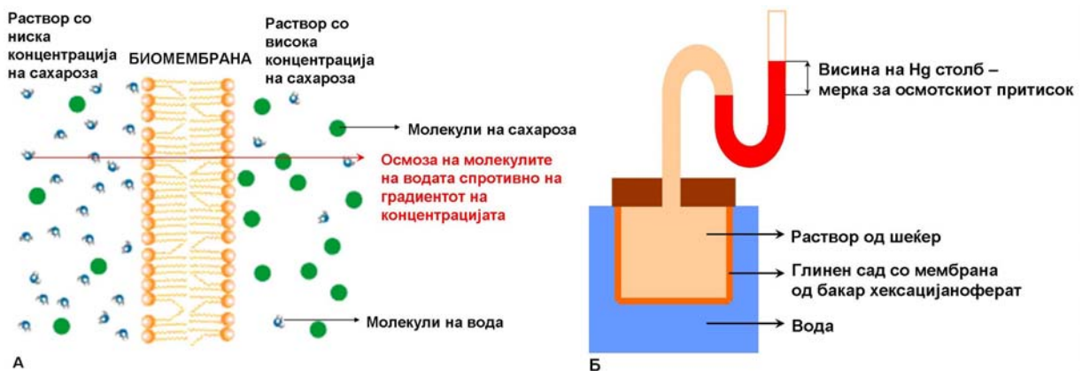
Сл. 1.17 (А) Осмоза на молекулите на водата низ семипермеабилна биомембрана. (Б) Pfeffer-ов осмометар. Мерењето на осмозата го определува количеството на примена или изгубена вода во клетката, а тоа зависи од концентрацијата на растворот и притисокот.
