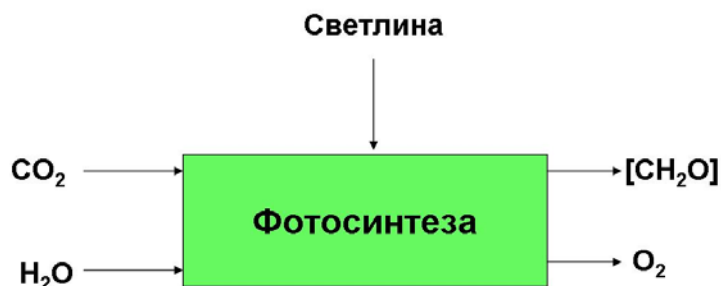
Сл. 6.1 Фотосинтезата е претставена како “црна кутија” во која се одвиваат непознати процеси, додека познатите процеси претставуваат “влез” (светлина, \text{CO}_2 и \text{H}_2\text{O} ) и “излез” ( \text{CH}_2\text{O} и \text{O}_2 ).
