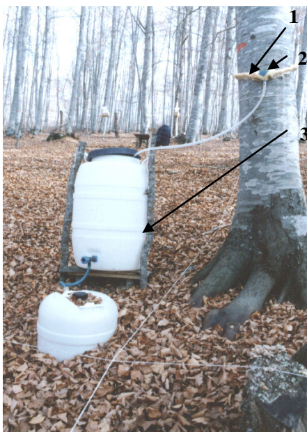
Сл. 9 Собирачи за стеблен оттек: 1. полиуретански прстен; 2. инка со црево; 3. собира на канта
