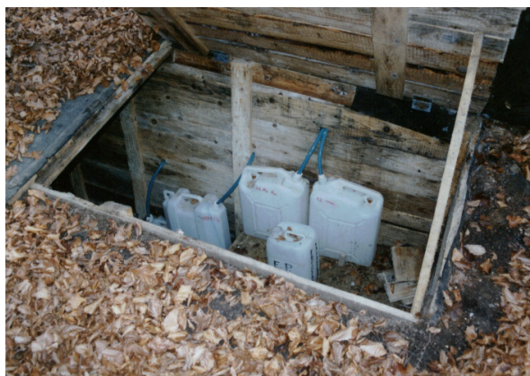
Сл. 18 Изглед на лизиметарската јама во која се поставени кантите за собирање на цедната вода од лизиметарските плочи на различни длабочини во почвата
