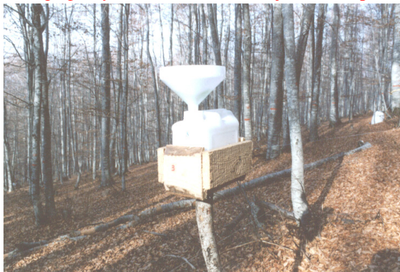
Сл. 8 Изглед на еден собирач за дожд под крошни
